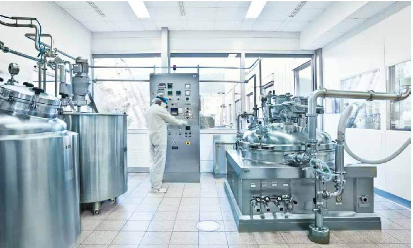
Die klein-volumigeren Produkte werden auf dem BECOMIX RW 1000CD (A. Berents GmbH & Co. KG) mit einer Ansatzgrösse bis max. 1000 kg halbautomatisch produziert.
