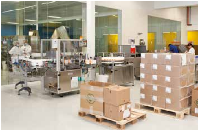
Dank strikter und klarer Zonentrennung mit Primärverpackung im Reinraum (im Hintergrund; abgetrennt durch Glasscheiben) und Sekundärverpackung unter kontrollierten Bedingungen kann vollkommen GMP-konform abgefüllt und verpackt werden.
