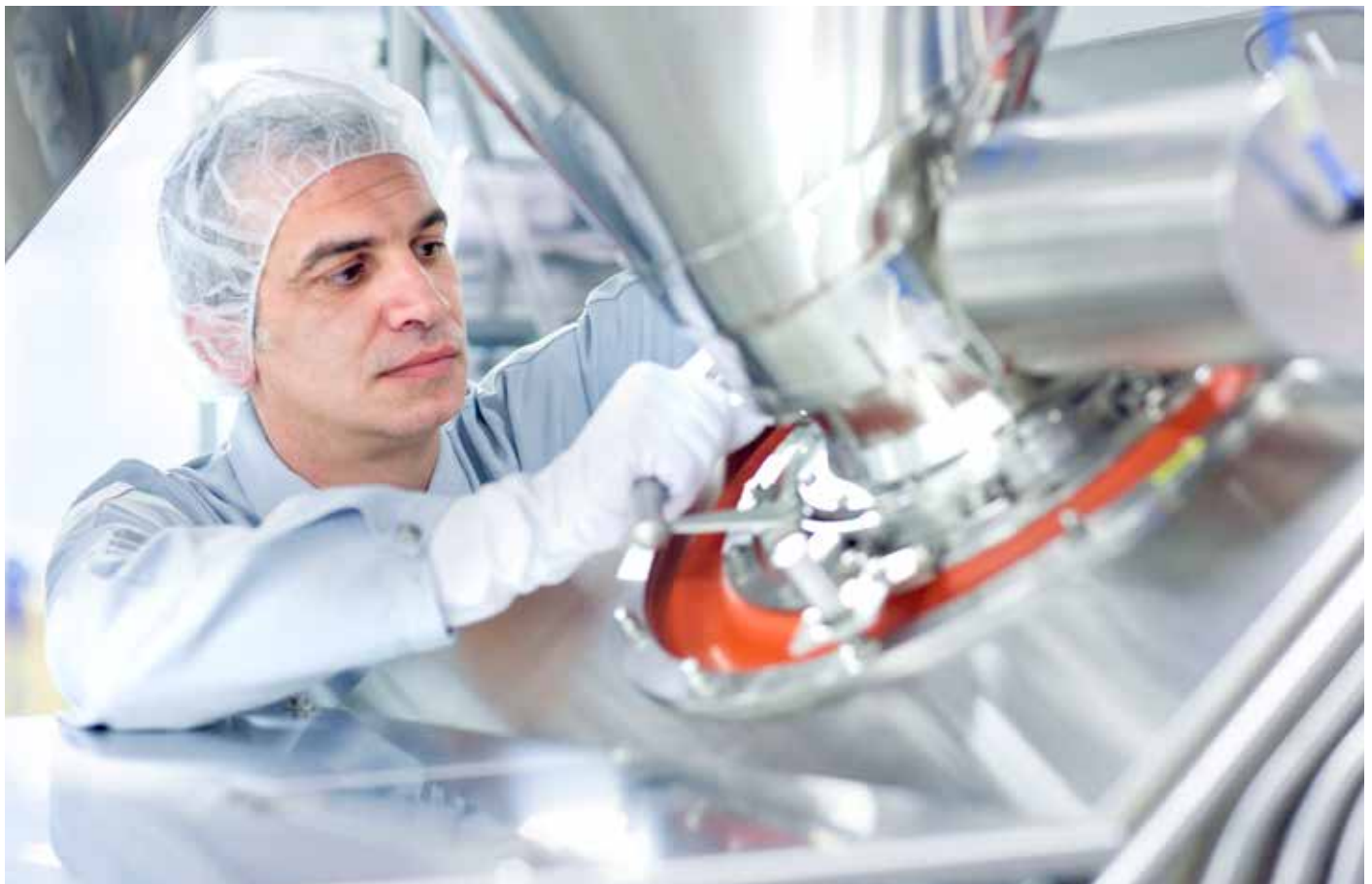
Mitarbeiter des Gefriertrocknungsmoduls beim Anschliessen eines Stopfentransferbehälters am Isolator mittels alpha-/beta Ports zur Aufrechterhaltung des geschlossenen Systems.
