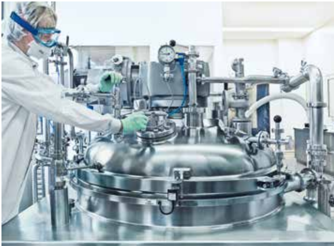
Visuelle In-process Kontrolle am Schauglas: Dem wachsamen Auge des geschulten und erfahrenen Operators entgeht nichts!
