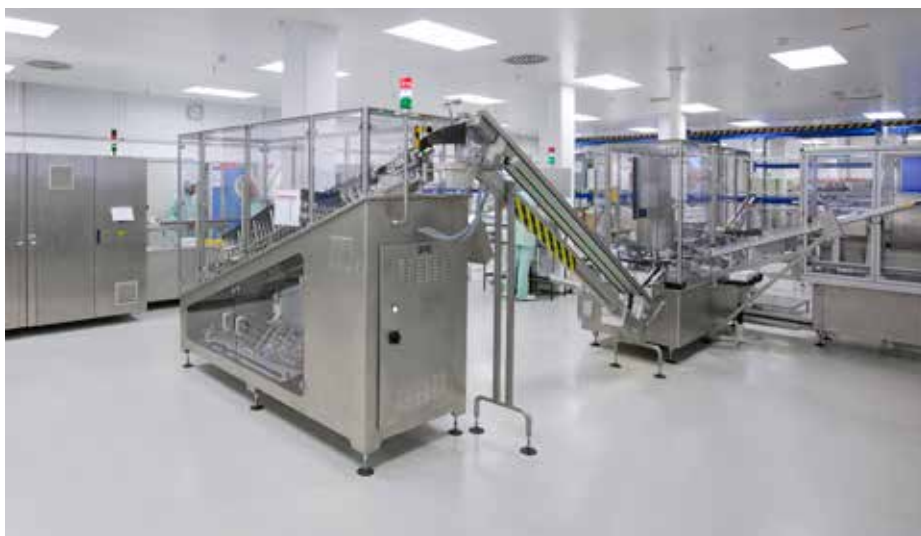
Kompakte vollautomatische Produktionsanlage zur rationellen Spritzenkonfektionierung (Kolbenstangenmontage – Etikettierung – Safety Device-Montage – Spritzenpufferung)
