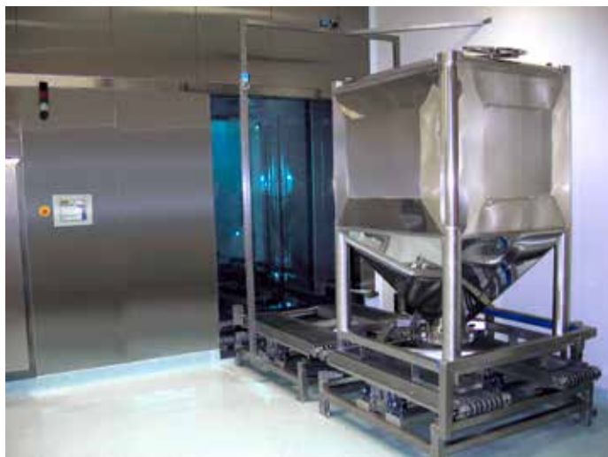
GMP-konforme Containerreinigung: Belimed Reinigungsanlage PH 880.2 mit integriertem Transportsystem.
