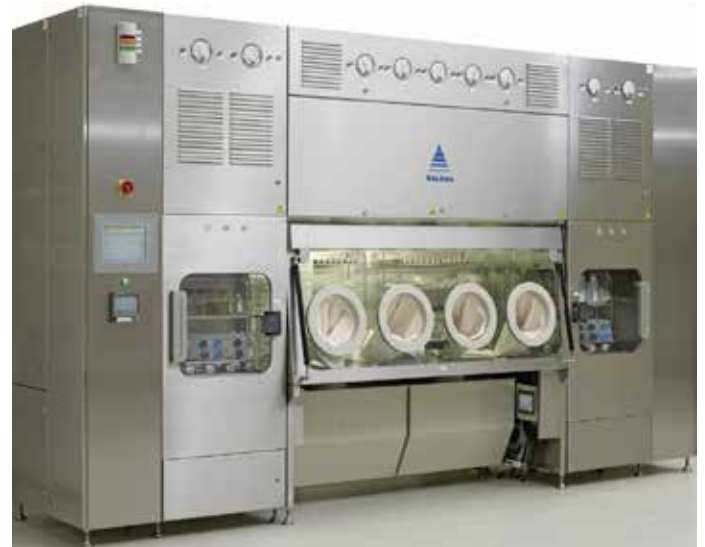
Modulare Isolatoren der Firma SKAN AG, Allschwil BL/Basel, zur Herstellung von Zytostatikallösungen und klinischen Prüfmustern (Foto: Aukamm Pharma GmbH & Co. KG, Wiesbaden/D bzw. Dr. Frank Stieneker, APV, Mainz/D).
