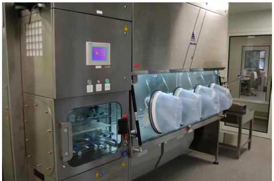
Modulare Isolatoren der Firma SKAN AG, Allschwil BL/Basel, zur Herstellung von Zytostatikallösungen und klinischen Prüfmustern (Foto: Aukamm Pharma GmbH & Co. KG, Wiesbaden/D bzw. Dr. Frank Stieneker, Mainz/D).
