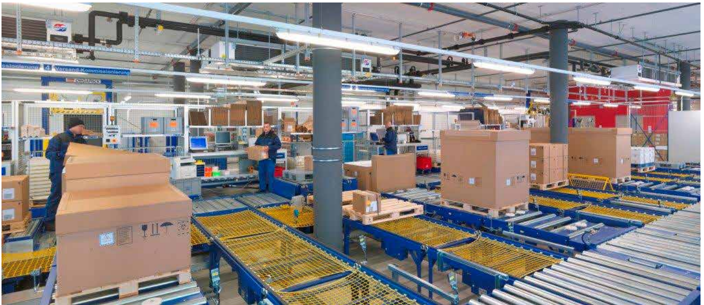
Kommissionierzone und Versandvorbereitung im Kühlbereich. In diesem Bereich werden alle notwendigen Kühlmaterialien für den Verpackungsbetrieb als auch für den Versand bearbeitet. Die Arbeitsplätze werden durch die Logistikanlagen automatisch mit dem richtigen Material versorgt.
