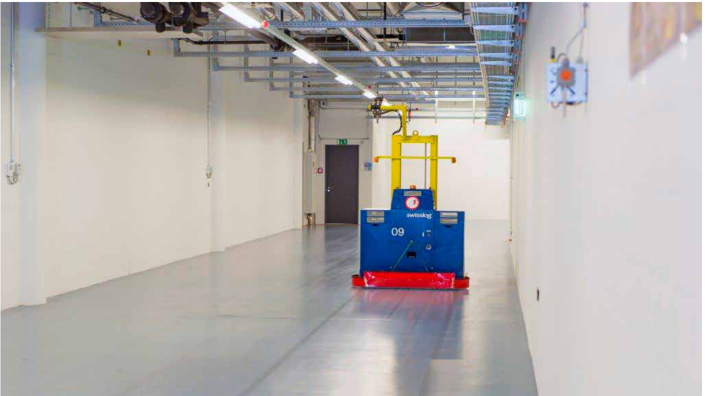
Fahrerlose Transportfahrzeuge. Diese Fahrzeuge stellen die Ver- und Entsorgung der verschiedenen Betriebe (Produktion und Verpackung) unterirdisch via eines Tunnelsystems sicher. Roche hat 15 solcher Fahrzeuge im Dauerbetrieb.
