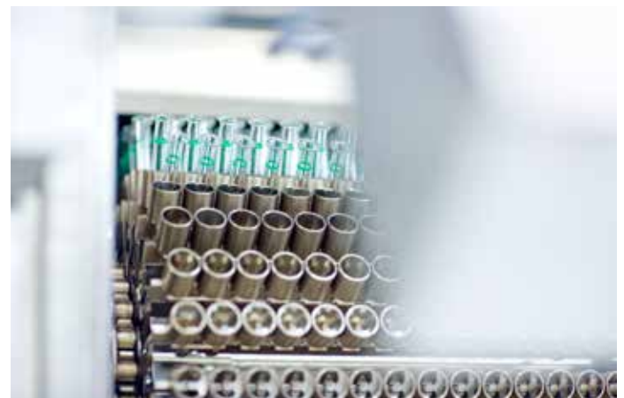
Blick auf das Förderband des Heisslufttunnels der Fertigspritzenlinie. Einzeltransport von Fertigspritzenkörpern durch den Tunnel mittels Hülsen.
