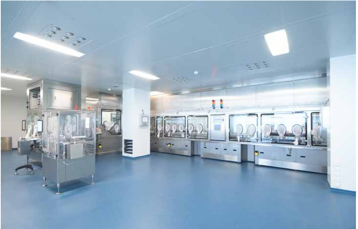
Entladeseite des Gefriertrocknungsmoduls in Isolatorausführung zur Erfüllung der Anforderung von Annex 1 EU-GMP-Guide und Mitarbeiterschutz.
