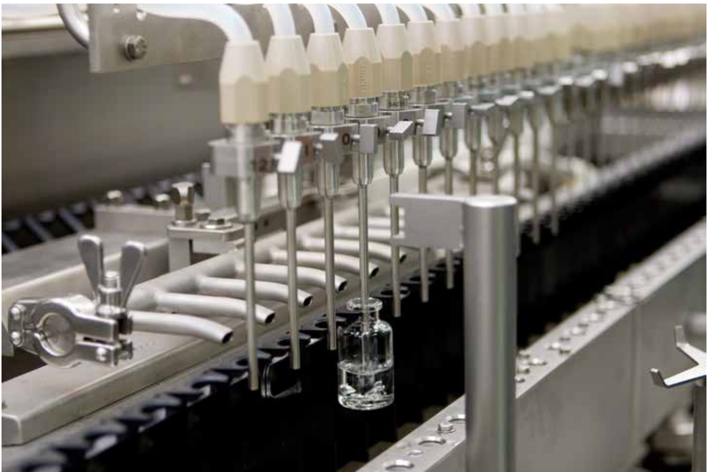
Abfüllstation für Vials mit Aerosolabsaugung und Nadelbalken zur Reinigung und Sterilisation der Abfüllnadeln.
