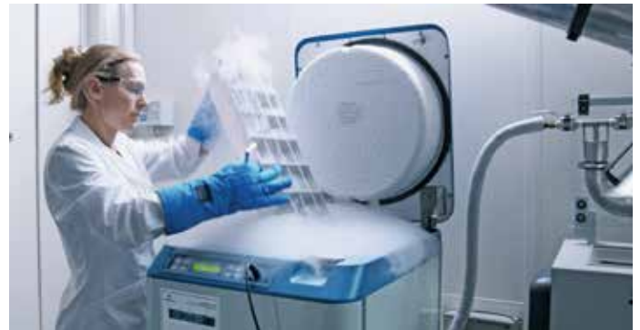
Anwendung von Flüssigstickstoff zum Einfrieren von Proben.
