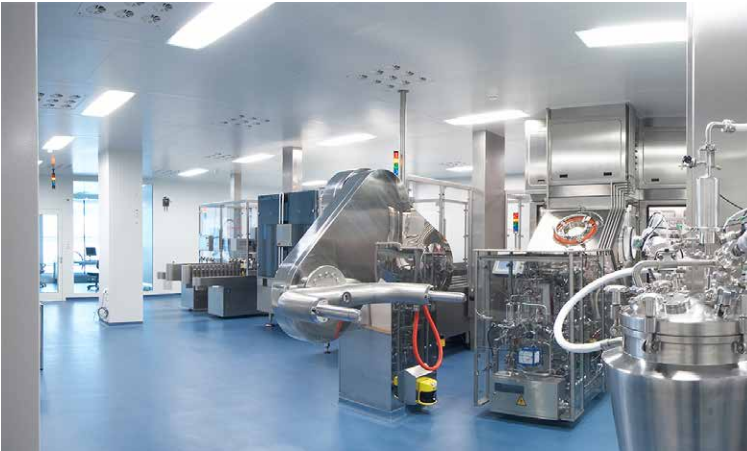
Panoramaaufnahme des Fertigspritzenmoduls mit Waschmaschine, Heisslufttunnel, Mediensäule, Andockstation für den Lösungskessel, CIP/SIP-Station, Hebevorrichtungen
