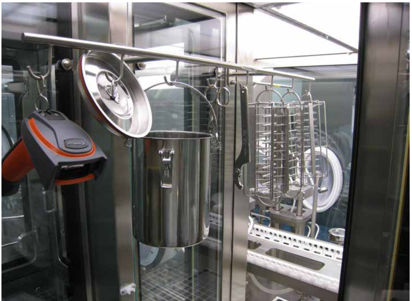
Blick in Isolator mit zur De-Kontamination (gasförmiges H_2O_2 ) vorbereiteten Materialien.
