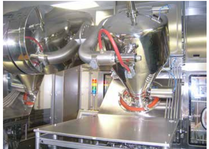
Etablierung eines geschlossenen Systems von der Lösungsherstellung bis zum Verschliessen der einzelnen abgefüllten Einheiten. Andocken von Stopfbehälter an Isolator mittels \alpha/\beta -Port.
