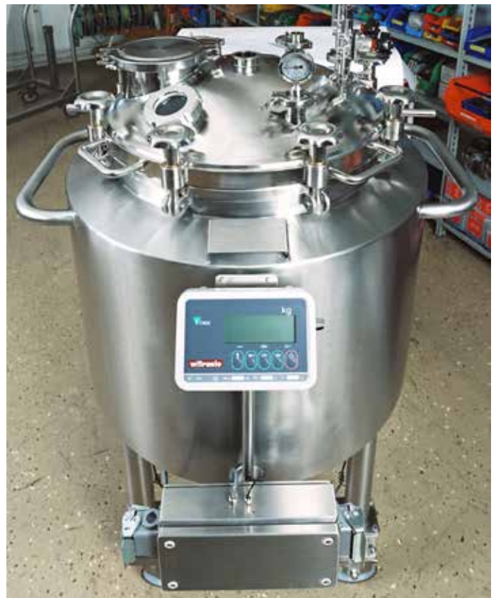
Abb. 13: Mobiler Behälter 250 Liter mit integrierter Bodenwaage. Die Kraftmessdosen sind direkt an den Füßen montiert. Der Behälter ist innen elektrolytisch, aussen geschliffen. Einsatz: Herstellung von Infusionslösungen.
