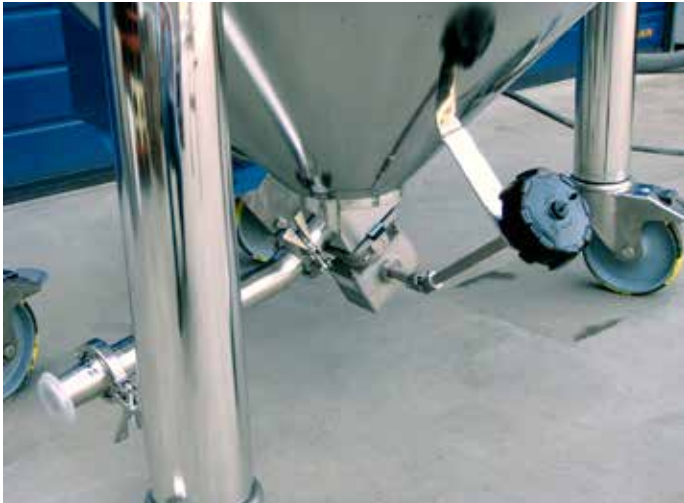
Abb. 10: Detail Bodenauslaufventil mit Anschlussstutzen im Gefälle. Bodenauslaufventil mit bedienerfreundlicher Handradverlängerung.
