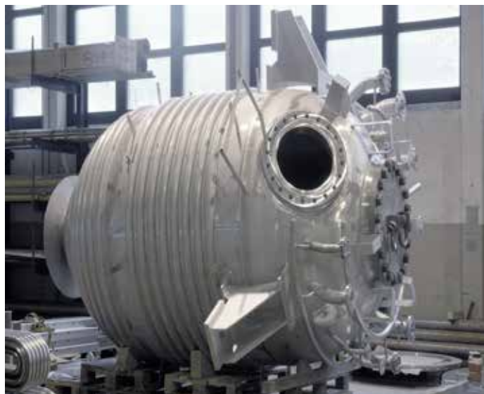
Abb. 1: Abnahmepflichtiger Chemiereaktor mit Heizschlangen und Wandstärken von 60 mm für die Polymerisation von hochwertigen Kunststoffen für den Fahrzeugbau. Einsatzbereich bei 200° C und 60 bar.
