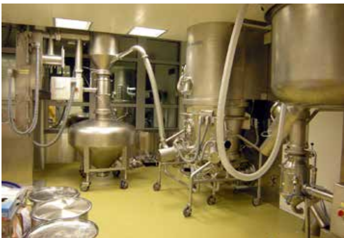
Dieses Bild gestattet einen Blick in das neueste Workcenter der Mepha AG. Es besteht aus den Hauptkomponenten Schnellmischer und Wirbelschichtanlage. Das Equipment stammt von der Firma OYSTAR Hüttlin.
