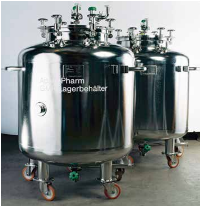
Abb. 2: Mobile Transportbehälter für die Andockung an ein Kippsystem. Zur Herstellung von halbfesten Darreichungsformen im Reinraum.
