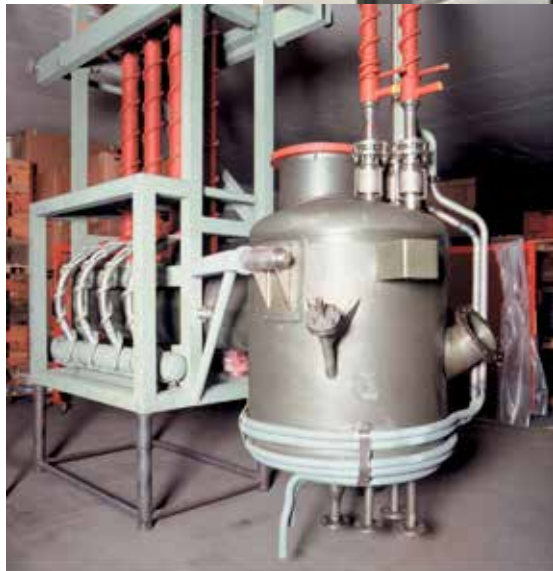
Abb. 4: Über Heizschlangen beheizbarer Apparat aus Reinnickel für die Aufkonzentrierung und die Verteilung von Natronlauge bei 400°C für einen Chemiebetrieb in China. Alle Medium berührende Komponenten aus Reinnickel.
