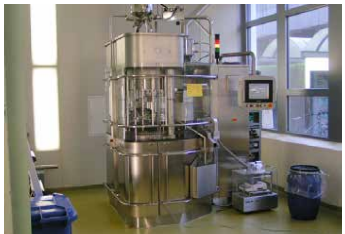
Blick auf eine Kapselfüllmaschine der Firma MG2. Mit dieser Anlage werden Mikrotabletten stückgenau den Kapseln zugeführt.
