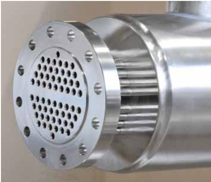
Abb. 6: Vollständig entleerbarer Wärmeaustauscher in DTS Design mit verschweissten, mechanisch bearbeiteten und verschliffenen nahtlosen Wärmeaustauschrohren mit der Rohrplatte. Der Apparat ist als platz sparende 2-Pass Konstruktion ausgeführt.
