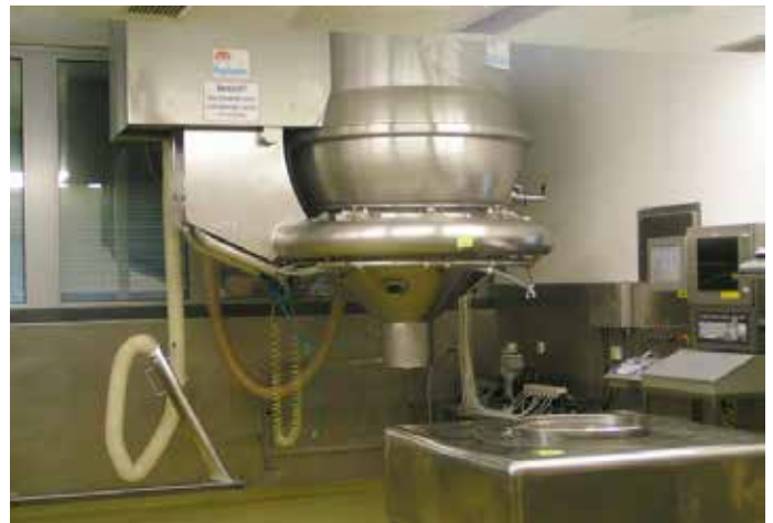
Dieses Granulierworkcenter ist seit 1992 in Betrieb. Im Jahr 2007 wurde eine umfangreiche Steuerungssanierung durch die Firma OYSTAR Hüttlin erfolgreich durchgeführt.
