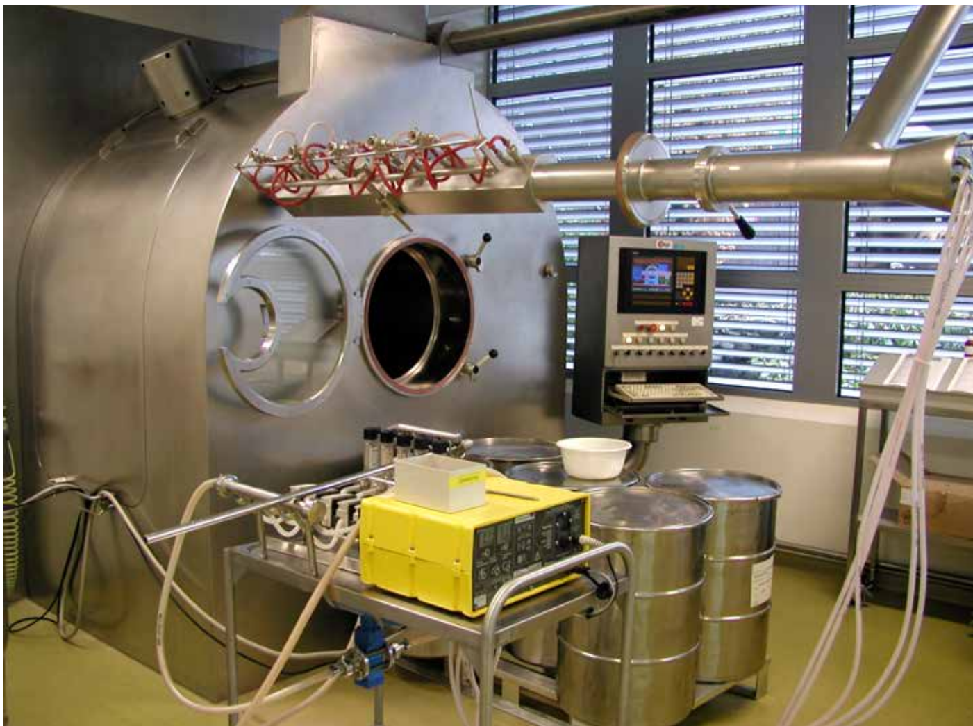
Ein Coater der Firma Glatt AG. Er bietet die Möglichkeit, Mikrotabletten zu coaten. Dabei wird ein spezieller Pelletsack eingelegt.
