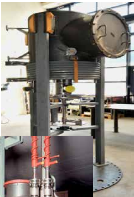
Abb. 5: Pharmawärmetauscher mit Sterilflanschanschluss. Vollständig entleerbar mit vollverschweisstem Isolationsmantel zur Aufheizung von WFI. Mit Schwarzdampf und Kondensatanschluss.
