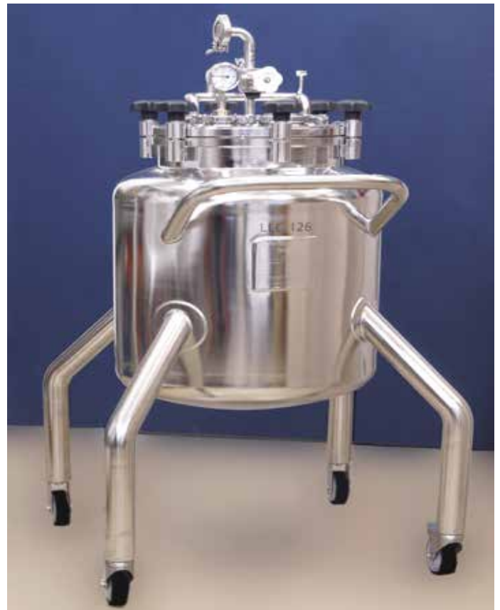
Abb. 16: Mobiler Behälter für lange Transportwege innerhalb eines Reinraumes. Innen und aussen elektropoliert. Für den Transport von Liquida mit integriertem CIP System.
