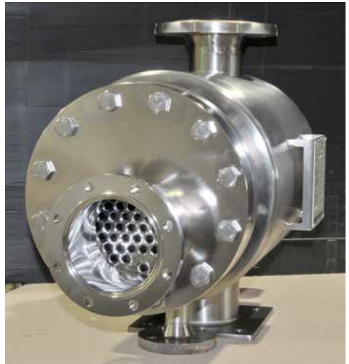
Abb. 5: Pharmawärmetauscher mit Sterilflanschanschluss. Vollständig entleerbar mit vollverschweisstem Isolationsmantel zur Aufheizung von WFI. Mit Schwarzdampf und Kondensatanschluss.
