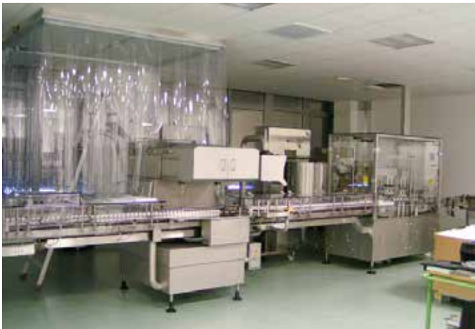
Neben 7 Blisterlinien der Firma Uhlmann ist bei der Mepha AG auch eine Flaschenlinie in Betrieb. Es können bis zu 100 Flaschen/min. stückgenau abgefüllt werden. Von der Aufgabe der Flaschen bis zum Etikettieren lieferte die Teilanlage die Firma Rudolf Deckert GmbH & Co. KG, und ab Kartonierer bis zum Bündelpacker war die Firma Uhlmann Lieferant.
