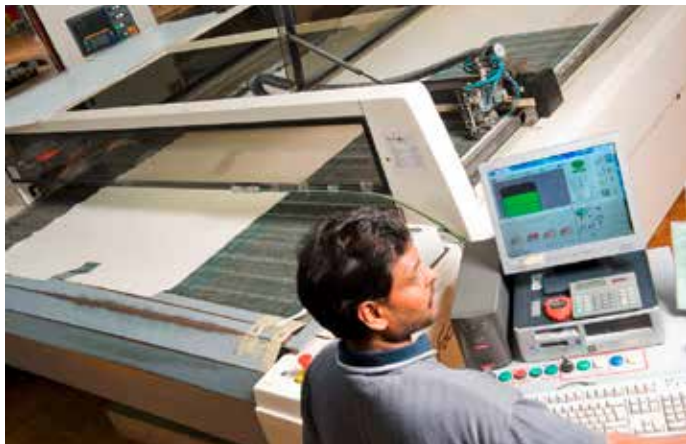
Hightech-Lasercutter CAD-gesteuert. Schnittbreite bis 248 cm.
