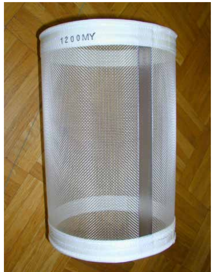
Siebzyylinder mit geschweisster Naht.
