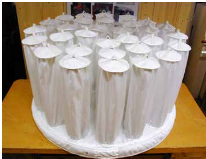
Im Hause konfektionierter Wirbelschichttrockner mit antistatischem Gewebe.
