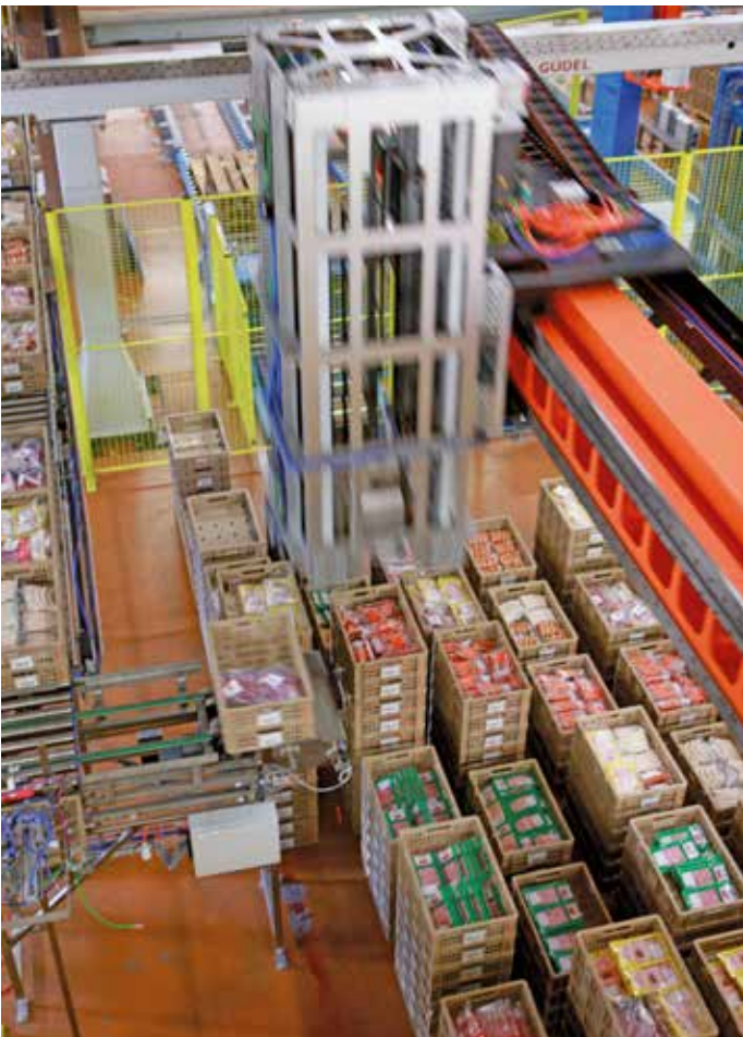
Blick in ein von der Güdel AG eingerichtetes Sortier- und Kommissionierlager in einem Lebensmittelverteilzentrum. Das Lager garantiert «First in, First out» und hat eine sehr hohe Verfügbarkeit (Bild: Güdel AG).
