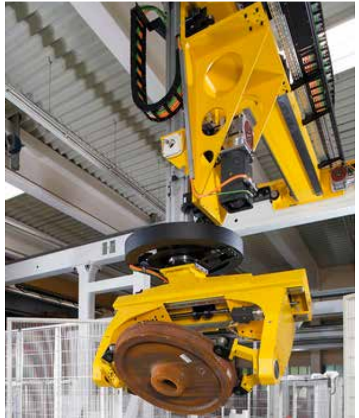
Die Güdel AG stellt vollautomatische Produktionslinien für die Bearbeitung von Eisenbahnrädern und Achsen her (Bild: Güdel AG)
