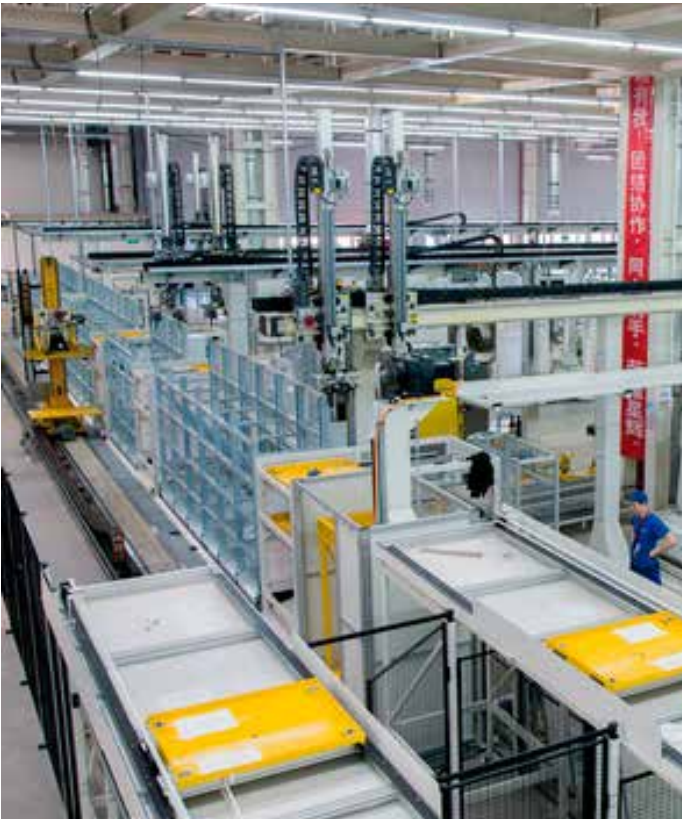
Eine automatische Linie für die Herstellung von Kurbelwellen in der Automobilindustrie (Bild: Güdel AG).
