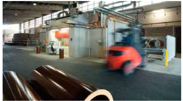
Das Bild zeigt eine Fräsmaschine für die Endenbearbeitung keramischer Abwasserrohre. Die von der Güdel AG hergestellte Maschine ist vollautomatisiert (Bild: Güdel AG).
