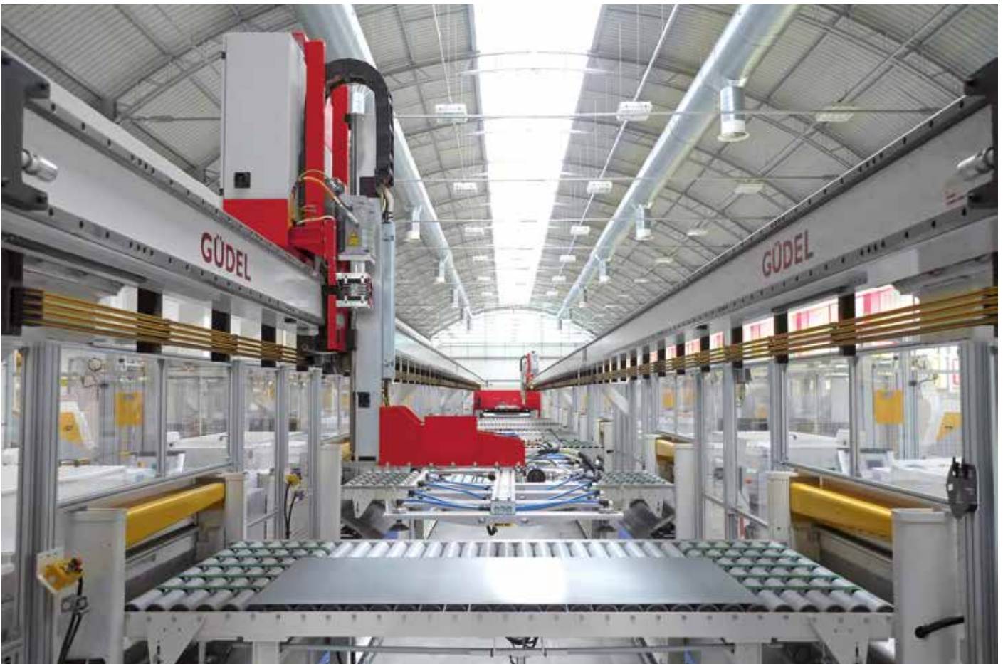
Durch den Einsatz von Wireless-Technologie in Kombination mit hochdynamischen Verfahrsachsen können auch grosse Blechteile schnellstmöglich durch eine Produktionslinie gefördert werden (Bild: Güdel AG).
